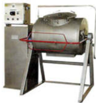
Рисунок 3.1 – Металлический безвальцовый маслоизготовитель
