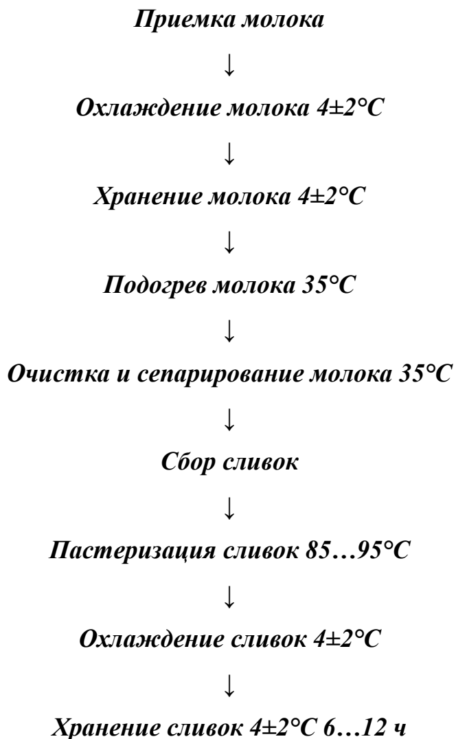
Рисунок 2.1 – Технологическая схема подготовки молока при выработке сливочного масла
