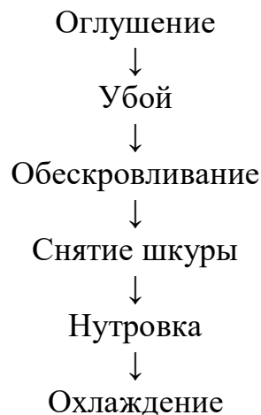
Рисунок 1.1 – Технологическая схема первичной переработки убойных животных
