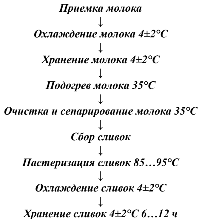
Рисунок 2.1 – Технологическая схема подготовки молока при выработке сливочного масла
