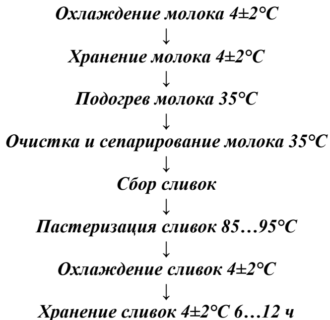
Рисунок 2.1 – Технологическая схема подготовки молока при выработке сливочного масла
