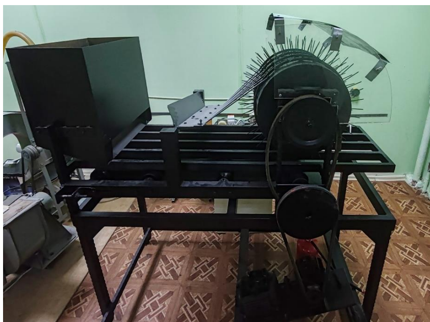
Рисунок 3 – Разработанная машина для предпосадочной обработки клубней картофеля в поле коронного разряда на кафедре электрификации
