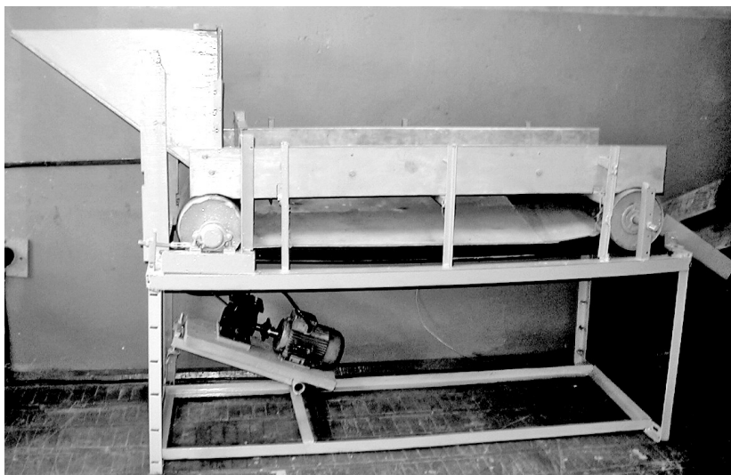
Рисунок 1 – Общий вид ленточного электрического многослойного стимулятора семян
